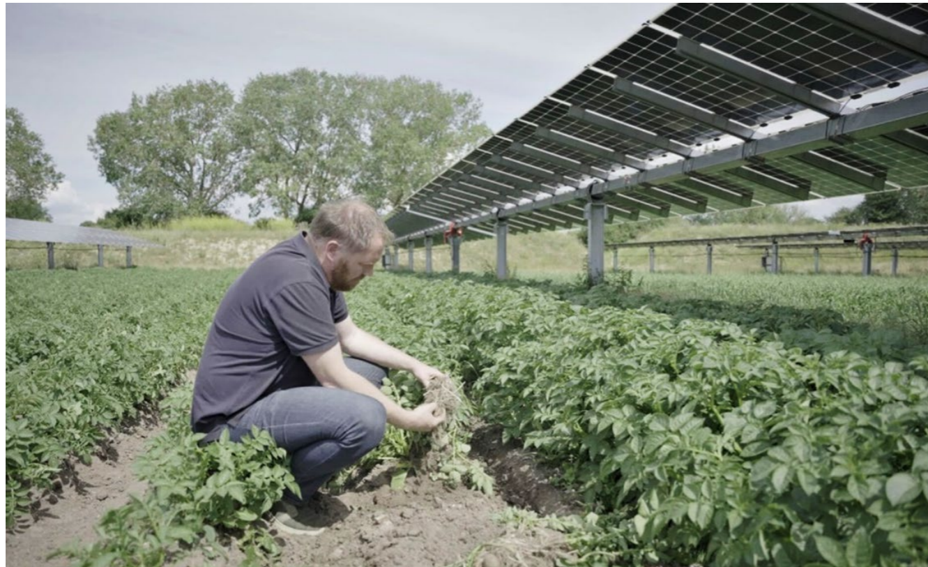
Foto: European Energy har i samarbejde med Innovationsfonden opført et mindre agri-pv forsøgsanlæg og er i proces med at undersøge synergierne mellem energiproduktion og fortsat landbrugsdrift. Forskellige afgrødetyper og rækkeafstande mellem panelrækkerne undersøges
